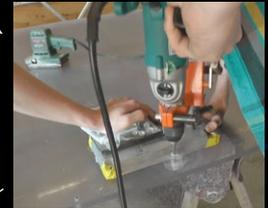
Schleifen und Bohren der transparenten Kletterfläche
